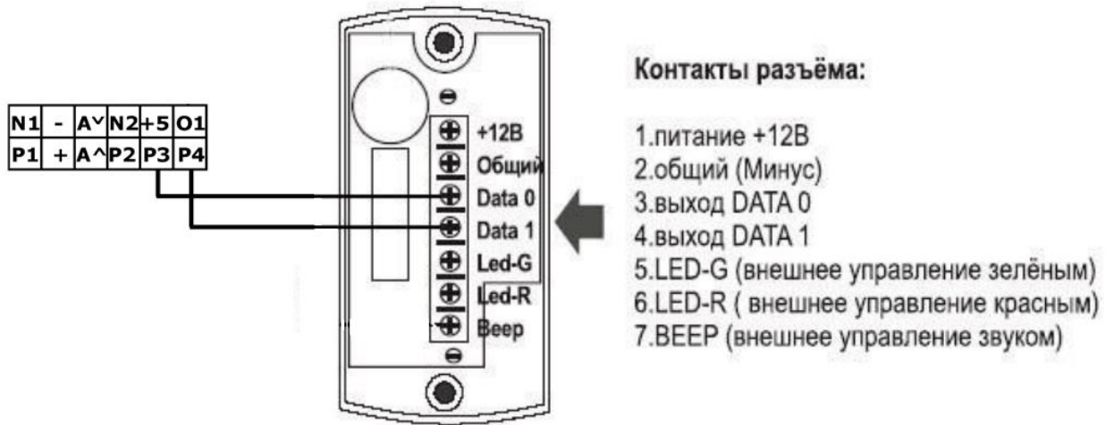
Рис. 6.1. Подключение считывателя Matrix 2 EH
